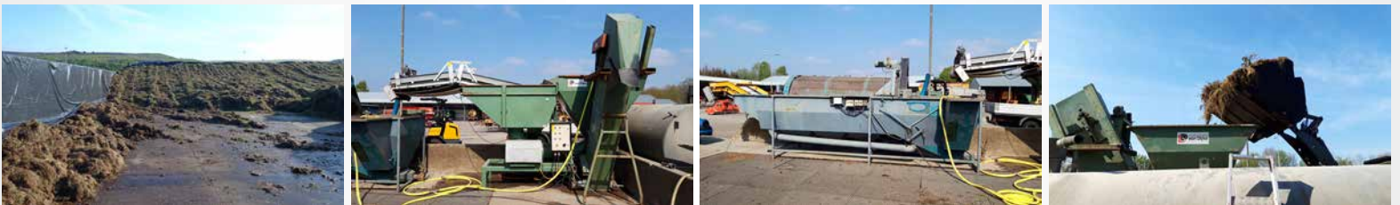
Bermgras wordt ontdaan van vervuilingen en verwerkt tot schoon bermgras voor biobased producten.
