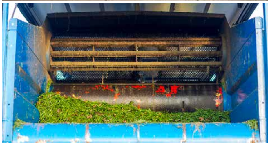
De veevoedersector wil een bepaald eiwit, niet zozeer soja uit Brazilië. Zo verwerkt de mobiele bioraffinage installatie van Grassa regionale gewassen tot een vezelproduct, eiwitconcentraat en een mineralenconcentraat. De verwachting is dat die producten hun weg vinden in de veevoedermarkt en (bio)meststoffen.
