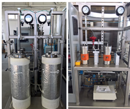
De SFT-NPX-10 SFE Medical Grade superkritische CO 2 -extractie-eenheid met twee extractor- en twee separatorvaten. Extractorvaten zijn elk 10 liter.
