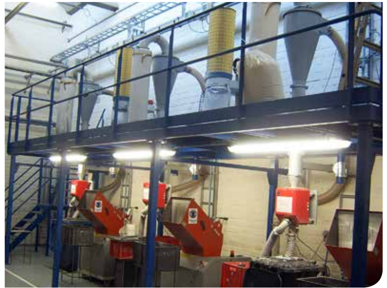
— Kunststofaanspuitstukken vermaalt het bedrijf zelf en het granulaat gaat de productie in.
