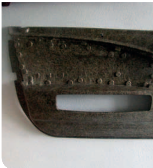
— Aan de muur een deurpaneel, deels geproduceerd met hennepvezels. Lichter en duurzamer, aldus HempFlax.
